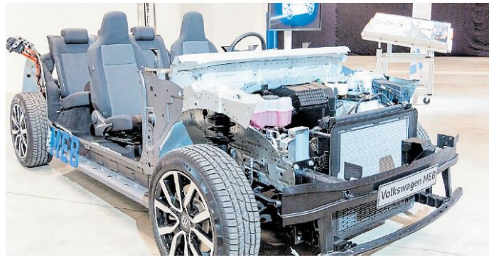
Das Fahrgestell des Elektroautos Volkswagen ID.3 zeigt das Modulare E-Antriebs-Baukastensystem. Man sitzt quasi auf den Akkus des Autos. DPA-BILD: JULIAN STRATENSCHULTE
